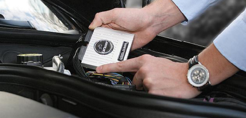
Einbau eines Zusatzsteuergerätes zur Leistungssteigerung
