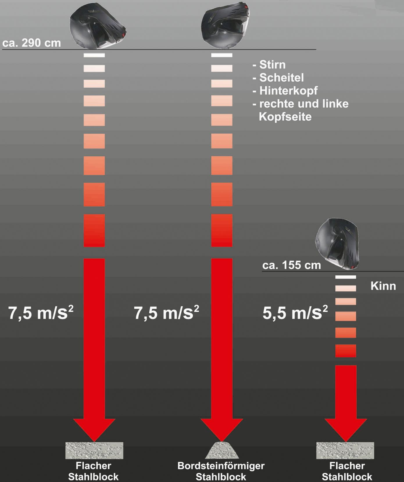
Die exakte Fallhöhe bestimmt sich nach vorgeschriebenen Aufprallgeschwindigkeiten von 7,5 m/s<sup>2</sup> und 5,5 m/s<sup>2</sup>.
